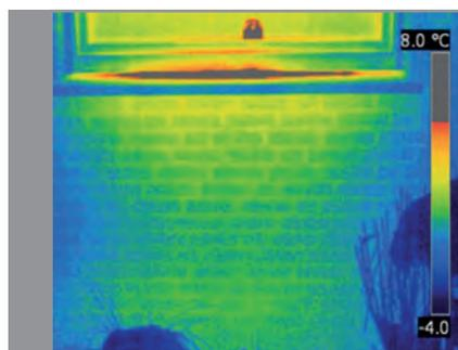
*Bild 8:* Heizkörpernische und Verbindung zw. innerer und äußerer Fensterbank, dadurch hohe Wärmeverluste.
